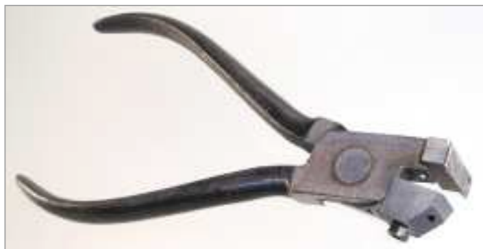
Abb. 10: Mit dieser Zange wurde bei älteren Tessinas der Steg des linken Aufschubrahmens vor dem Blenderrändel herausgezwickelt, um eine Koppelung mit dem Tessina-Belichtungsmesser zu ermöglichen.
