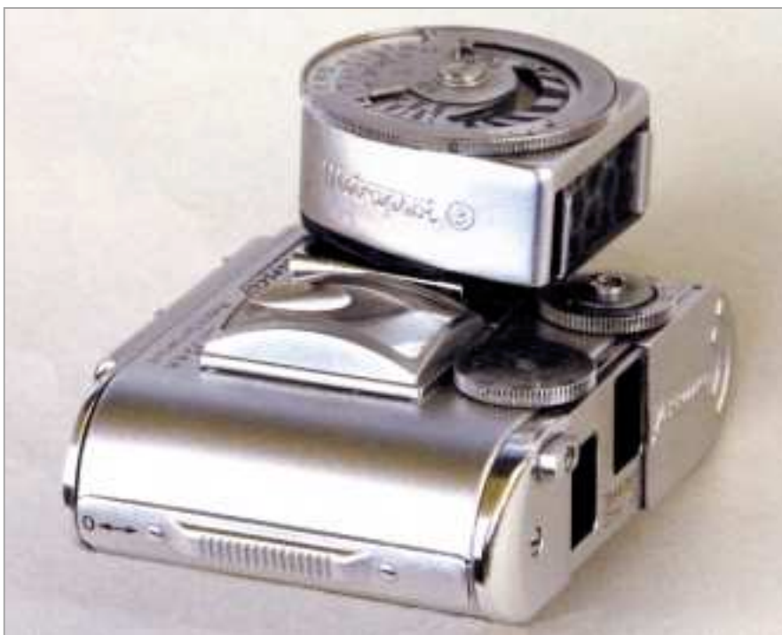
Abb. 6: Der Metraphot 3 mit Normalfuß steckt in einem Spezialschuh auf der Tessina.
